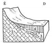
3. *ábra*. A Harsányi-hegy lejtőlábi térségének geológiai szelvénye. -1 = karbonátos kőzetek; 2 = durva lejtőtörmelék; 3 = iszapos sárga homok; 4 = lösz Geological profile on the foothills of Harsány Hill. -1 = carbonate rocks; 2 = coarse slope detritus; 3 = silty yellow sand; 4 = loess
