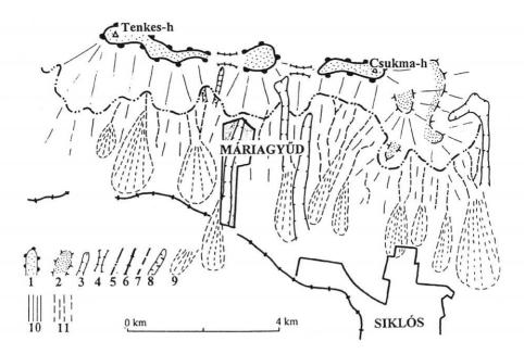
5. *ábra.* A kutatott terület geomorfológiai térképe. -1 = hegyhát; 2 = felszínlépcső; 3 = eróziós völgy; 4 = domborzati nyereg; 5 = lejtőtörés; 6 = teraszperem; 7 = löszmélyút; 8 = eróziós árok; 9 = törmelékkúp; 10 = stabil lejtő; 11 = instabil lejtő
